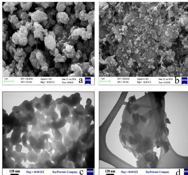
**Fig. 2.** SEM images of LFP/C<sub>in</sub> (a); LFP/C<sub>ex</sub> (b) and TEM images of LFP/C<sub>in</sub> (c); LFP/C<sub>ex</sub> (d)
